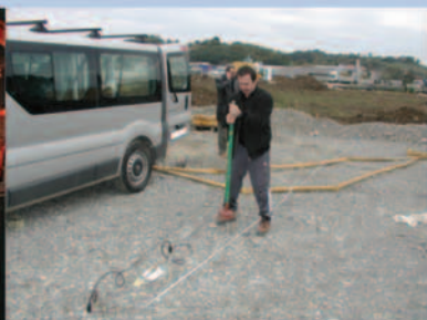
Mjerenje krutosti tla SASW metodom
